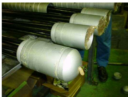
図 5.6.5 防錆材の充填
