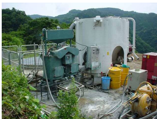
図 5.10.1 二槽式グラウトミキサーおよび小型セメントサイロからなる注入プラントの例
