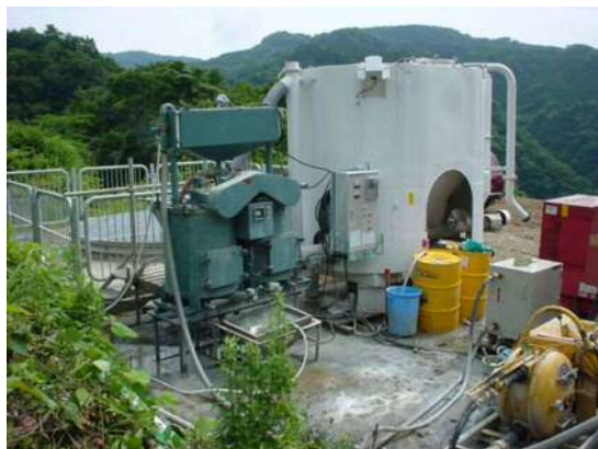
図 5.9.1 二槽式グラウトミキサーおよび小型セメントサイロからなる注入プラントの例
