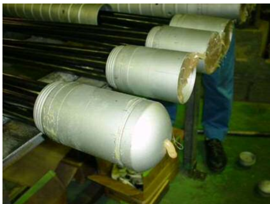
図 5.6.6 防錆材の充填
