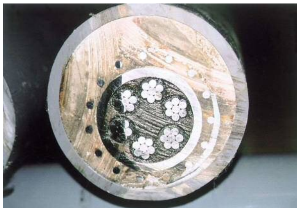
図 1.2.5 アンカー体部の防食構造
