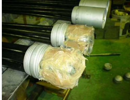
図 3.5.6 固定金具内の充填状況
