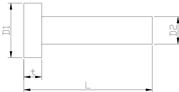
図 3.4.4 QSA 用ヘッドアダプターの形状
