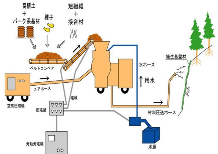
施工プラントは、従来の植生基材吹付工で使用する同様の機器で施工可能
