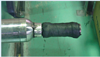
3 先端部スパン シールテープ 取付
